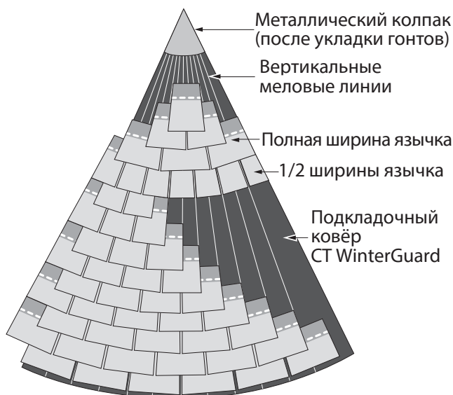
Рис. 9-6. Укладка гонта на закруглённую часть крыши.
