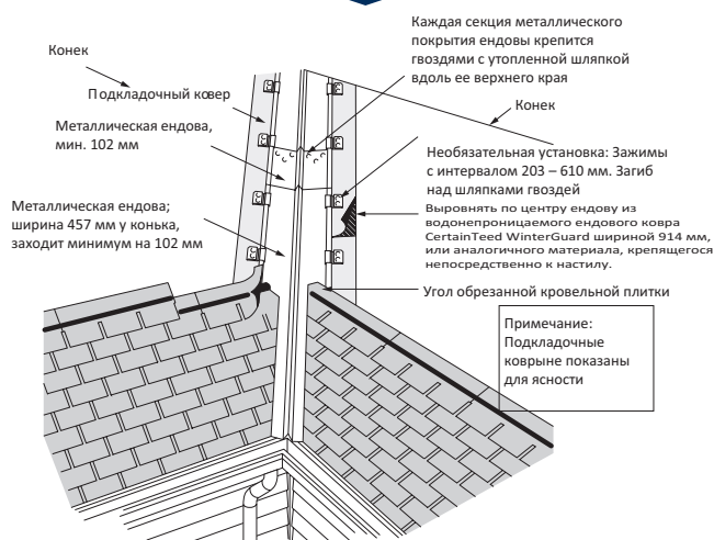
Рис. 6-20: Типичная закрепленная клеммерами открытая ендова
