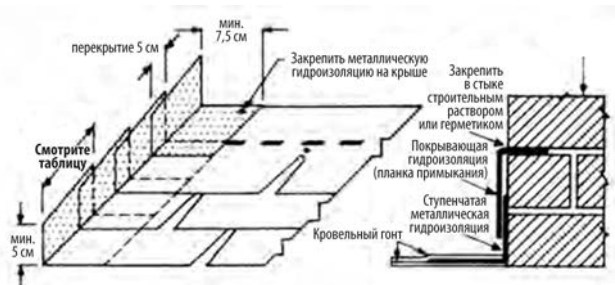
Рис. 6-2: Сступенчатая гидроизоляция боковой стены (см. также Рис. 6-10)
