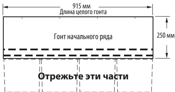
Рис. 14-10. Укладка гонтов начального ряда вдоль краёв ската.
