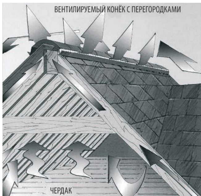
Рис. 7-12. На крышах L-образной и T-образной формы вентиляционные секции должны быть размещены как вдоль длинных, так и вдоль коротких коньков, поскольку все зоны чердачного помещения сопряжены друг с другом. Если высота коньков отличается более чем на 1 м, то вентилируемый должен быть только самый высокий конёк, либо установите перегородки в чердачном помещении.
