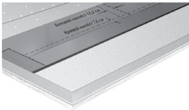
Рис. 5-19. Уложите лист подложки Cap таким образом, чтобы сдвиг относительно нижних краевых нахлёстов составлял не менее 46 см.
