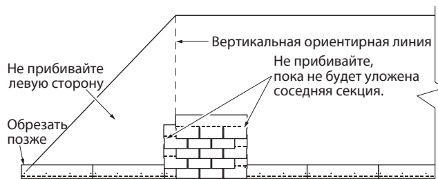
Рис. 9-5. Вертикальная секция гонта.
