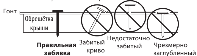
Рис. 11-2. Правильная и неправильная забивка гвоздей.
