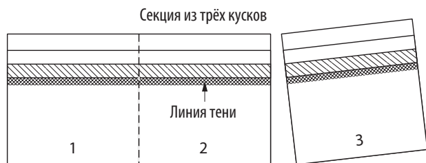
Рис. 12-18. Разделите, чтобы получить 3 покрывающих гонта.
