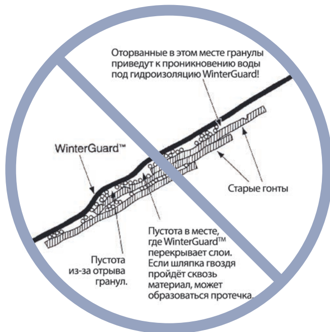
Рис. 5-4. Проблемы, возникающие при укладке WinterGuard на крышу.
