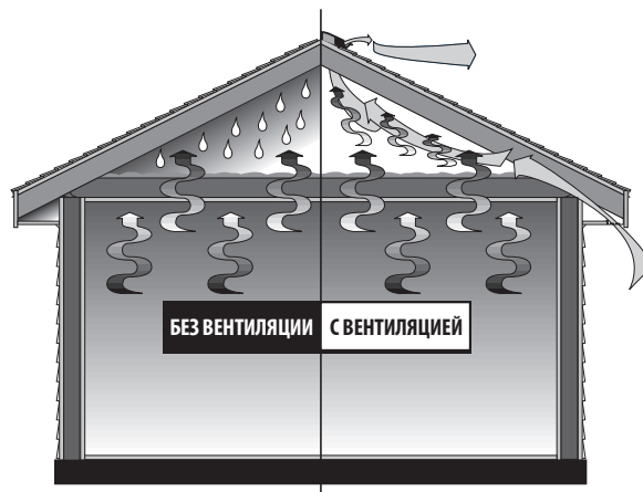
Рис. 7-8. Вентиляция чердачного помещения за счёт теплового эффекта.
