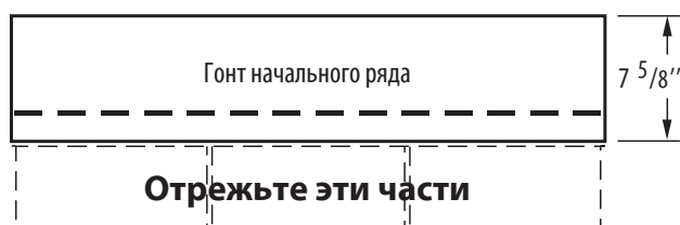
Рис. 12-6. Высота гонтов должна составлять не менее 194 мм.
