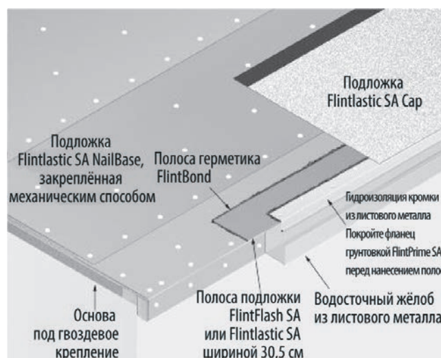
Рис. 5-30. Конструктивные особенности водосточного желоба в двухслойной системе.
