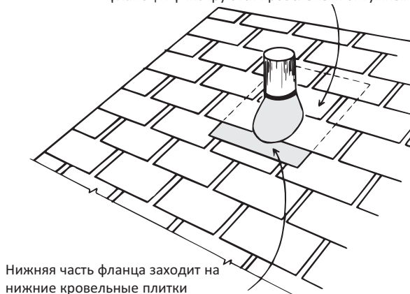
Рис. 6-7: Укладка кровельных гонтов вокруг фланца.
