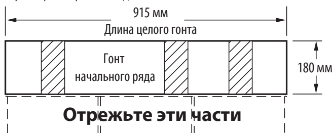
Рис. 13-8. Изготовьте гонты начального ряда, отрезав 5-дюймовые язычки.
