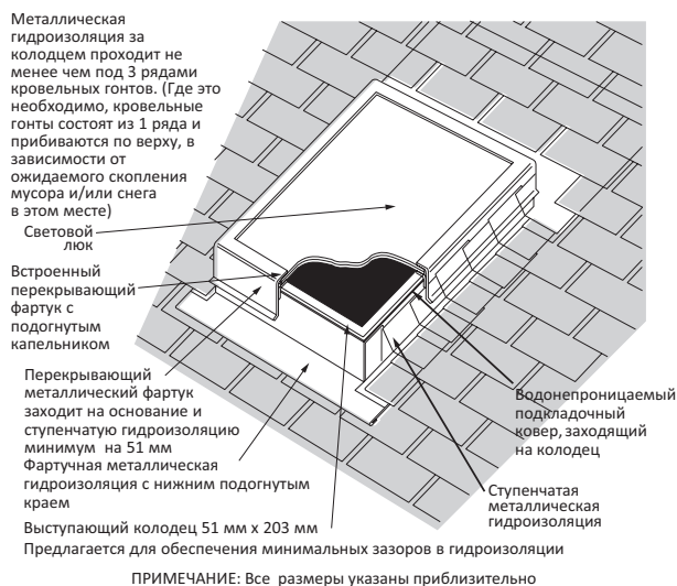
Рис. 6-26: Основные детали из листового металла, используемые со световым люком
