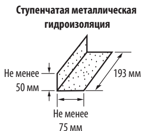
Рис. 12-10. Минимальные размеры ступенчатой гидроизоляции.
