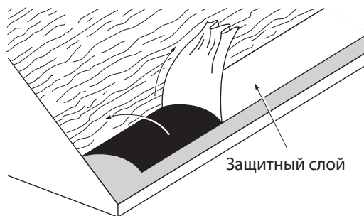
Рис. 5-6. Укладка методом «задираания и прижима».
