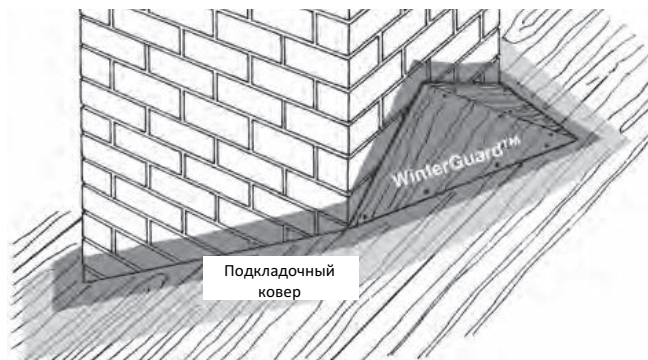
Рис. 6-8: Дымоход через настил крыши.
