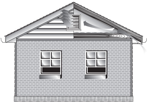
Рис. 7-17. Фронтовое жалюзийное отверстие для выхода воздуха, позволяет лишнему воздуху выходить из чердачного помещения. Отверстия располагаются по краям чердака.
